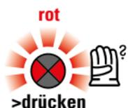
**Etwaige Messfehler**, beispielsweise durch das Tragen eines Handschuhs beim Einschaltvorgang, werden durch **rotes Blinken** der Signaleinheit angezeigt. Der PRCD-S<sup>+</sup> von PCE gibt in solchem Fall eine optische Warnung aus und schaltet nicht ein.
