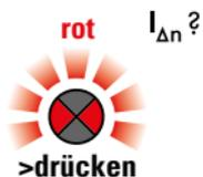
**Differenzstromfehler** wird durch **rotes Blinken** der Signaleinheit angezeigt. Der PRCD-S<sup>+</sup> von PCE gibt in solchem Fall eine optische Warnung aus und schaltet sofort ab. Der Schutzleiter bleibt bis zum Quittieren geschlossen!
